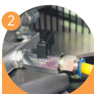
2 Cambio de aceite / Oil drain
