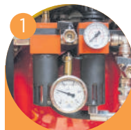
1 Tratamiento de aire/ Treatment of air
